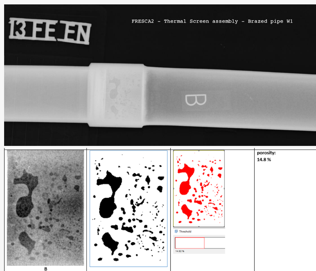
Contrôle d'une brasure forte puis analyse du taux de manques
