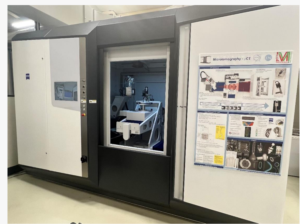
Contrôle d'une brasure forte puis analyse du taux de manques
