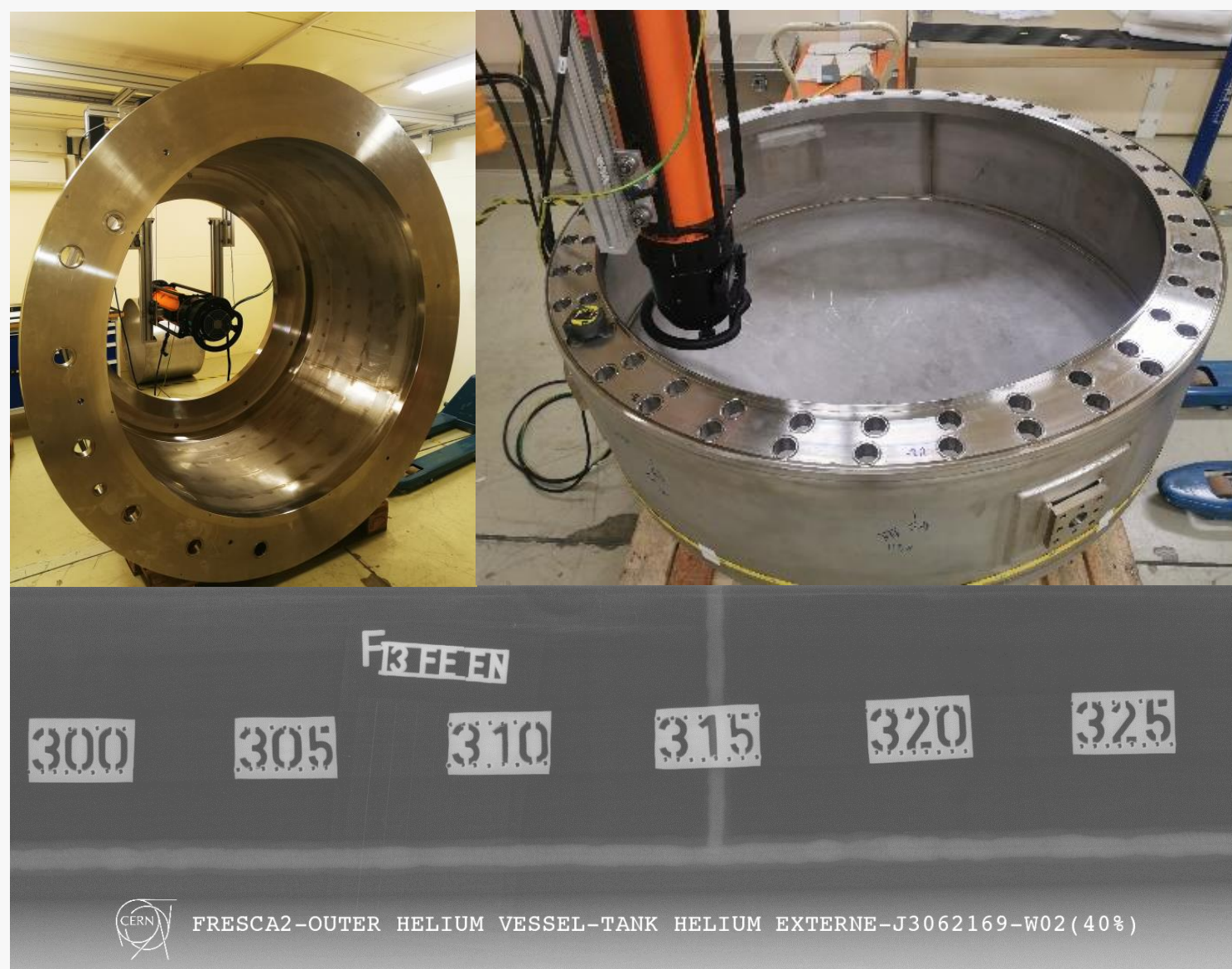
Contrôle de soudures sur les enceintes hélium pour le projet FRESCA2
